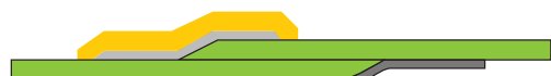
Szef na zakład przykrywany taśmą, wzmocniony dodatkową przezroczystą taśmą i podklejany taśmą
